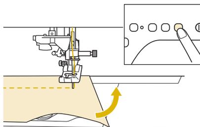
Il peut être utile de régler le pivotement lorsque l'on change de sens de couture. Lorsque la machine s'arrête en coin de tissu, l'aiguille reste plantée dans le tissu et le pied-de-biche se lève automatiquement, permettant de tourner facilement le tissu (« Pivotement » à la page 89).
