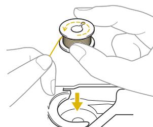
Si la canette est insérée de sorte que le fil se déroule dans le mauvais sens, la tension du fil lors de la couture sera incorrecte.
