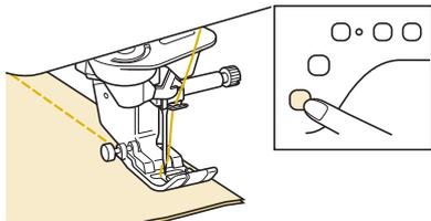
→ La machine s'arrête avec l'aiguille dans le tissu et le pied-de-biche se relève.
