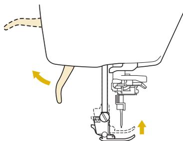
\* Si le pied-de-biche n'est pas relevé, la machine ne peut pas être enfilée correctement.
