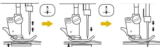
\* Lorsque l'aiguille est presque baissée par pression sur la touche « Position de l'Aiguille », les griffes d'entraînement s'abaissent. Il est alors possible de tourner le tissu pour ajuster avec précision le point de chute de l'aiguille.
