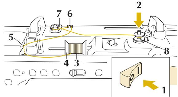
**1** Mettez la machine sous tension, puis ouvrez le capot supérieur.
