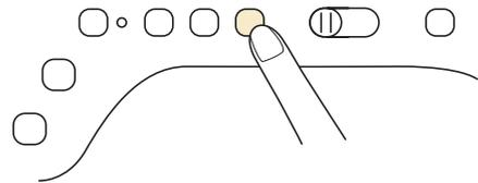
**11** Passez le fil par les disques de guide-fil (indiqués par un « 7 »). Assurez-vous que le fil passe par la rainure du guide-fil.
