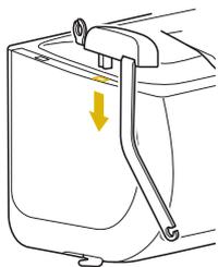
Passez le fil dans le guide-fil télescopique et le guide-fil
