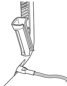
**2** La partie plate du stylet à double utilisation tournée vers la machine, insérez-le dans le porte-stylet à double utilisation.
