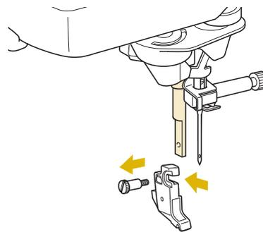
**4** Placez l'adaptateur sur la barre du pied-de-biche en alignant le côté plat de l'ouverture de l'adaptateur sur le côté plat de la barre du pied-de-biche. Relevez-le au maximum, puis serrez fermement la vis à l'aide du tournevis.
