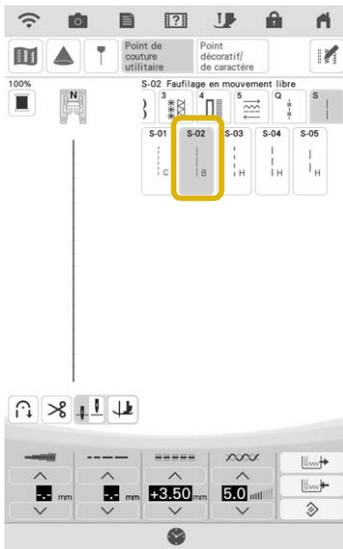
→ Le pied-de-biche est relevé à la hauteur nécessaire pour une couture en mouvement libre, et les griffes d'entraînement sont baissées.
