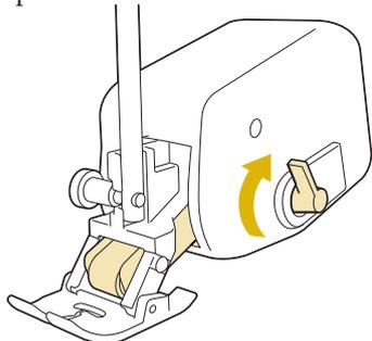
Si le levier de réglage des griffes d'entraînement est en position basse, le rouleau noir du pied à double entraînement est actionné.
