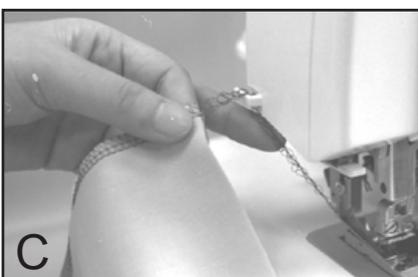
Placez les fils d'aiguilles et du boucleur supérieur sous le pied et vers l'arrière, abaissez le pied presseur. Pendant que vous tenez les fils avec votre main gauche, appuyez doucement sur le contrôleur pour commencer une chaîne de fil avant de surjeter le tissu (fig. A).
