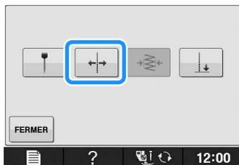
→ L'écran de réglage de la position de référence s'affiche et le traçage de la ligne de guidage rouge clignote lorsqu'il se trouve au niveau de la position de couture de la machine.
