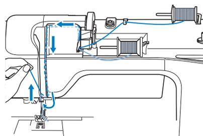
**8** Poursuivez l'enfilage, mais ne faites pas passer le fil dans le guide-fil « 6 » de la barre de l'aiguille. Enfilez l'aiguille du côté droit.
