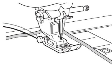
**14** Tout en maintenant légèrement les fils à l'arrière de la machine, tournez la molette pour refaire passer l'aiguille dans le tissu ou le trou percé, puis abaissez le levier du pied-de-biche.
