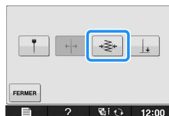
→ L'écran de réglage de la largeur de point s'affiche et le traçage de la ligne de guidage clignote lorsqu'il se trouve au niveau du côté gauche de la largeur de point.
