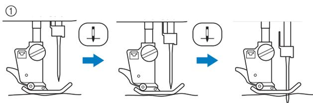
\* Lorsque l'aiguille est presque baissée par pression sur la touche « Positionnement aiguille », les griffes d'entraînement s'abaissent. Il est alors possible de tourner le tissu pour ajuster avec précision le point de chute de l'aiguille.
