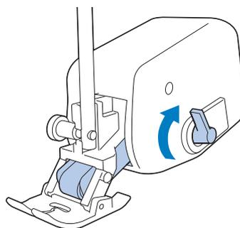
Si le levier de réglage des griffes d'entraînement est en position basse, le rouleau noir du pied à double entraînement est actionné.
