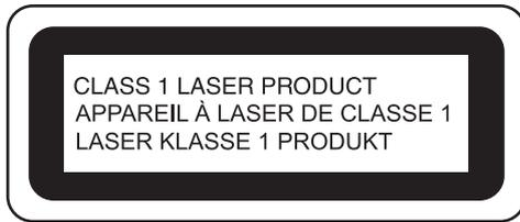
Le rayon laser émis par l'unité laser installée dans cette machine est limité à un niveau sans danger. En revanche, la machine contient des diodes laser InGaAlP de 7 milliwatts et d'une longueur d'onde de 650 à 660 nanomètres, d'un angle de divergence parallèle de 6 à 12 degrés et d'un angle de divergence perpendiculaire de 24 à 34 degrés. Par conséquent, si vous essayez de démonter ou de modifier la machine, vous pourriez subir des lésions oculaires.
