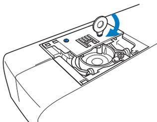
Tournez la molette pour vérifier que les griffes d'entraînement se déplacent librement et n'entrent pas en contact avec les bords des fentes dans la plaque d'aiguille.
