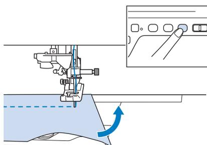
Il peut être utile de régler le pivotement lorsque l'on change de sens de couture. Lorsque la machine s'arrête en coin de tissu, l'aiguille reste plantée dans le tissu, et le pied-de-biche se lève
