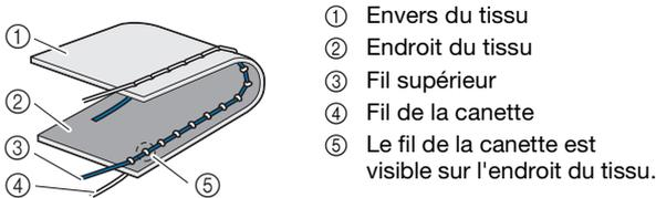
Tournez la molette de réglage de la tension du fil dans le sens inverse des aiguilles d'une montre pour réduire la tension du fil supérieur.
