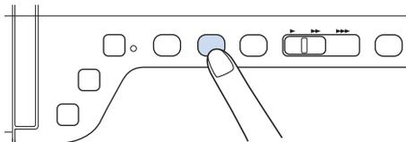
→ L'aiguille retourne automatiquement en position haute.
