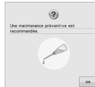
Lorsque ce message s'affiche, il est recommandé de confier votre machine à un revendeur agréé ou au centre de service agréé le plus proche pour un contrôle de maintenance de routine. Ce message disparaît et la machine continue de fonctionner une fois que vous appuyez sur **OK**. Mais il s'affichera encore plusieurs fois, jusqu'à ce que l'opération de maintenance appropriée soit effectuée.
