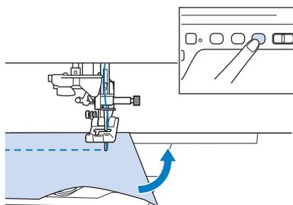
Il peut être utile de régler le pivotement lorsque l'on change de sens de couture. Lorsque la machine s'arrête en coin de tissu, l'aiguille reste plantée dans le tissu, et le pied-de-biche se lève automatiquement, permettant de tourner facilement le tissu (« Pivotement » page S-15).
