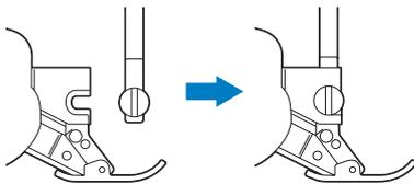
**3** Maintenez en place le pied à double entraînement de la main droite, puis serrez fermement la grosse vis à l'aide du tournevis fourni.
