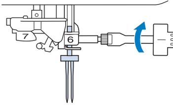
**2** Enfilez la machine pour la première aiguille, en suivant la procédure d'enfilage pour aiguille simple (« Enfilage supérieur » page B-46).
