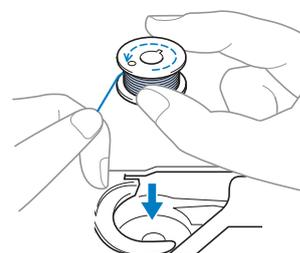
Si la canette est insérée et que le fil se déroule dans le mauvais sens, la tension du fil sera incorrecte.
