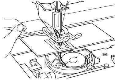
→ Une boucle formée par le fil de la canette sort par le trou de la plaque de l'aiguille.
