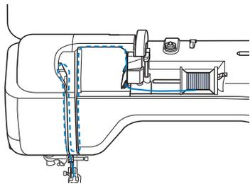
**3** Faites passer le fil par les guide-fils de la barre de l'aiguille, puis enfiler manuellement l'aiguille du côté gauche.
