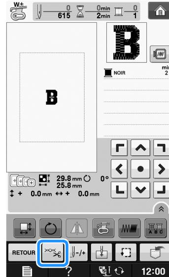
2 Appuyez sur
