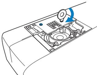
Tournez le volant pour vérifier que les griffes d'entraînement se déplacent librement et n'entrent pas en contact avec les bords des fentes dans la plaque d'aiguille.
