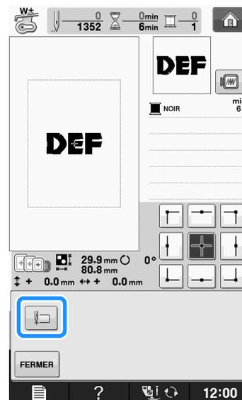
→ L'aiguille est positionnée sur le coin inférieur gauche du motif. Le cadre de broderie se déplace de sorte que l'aiguille soit correctement positionnée.
