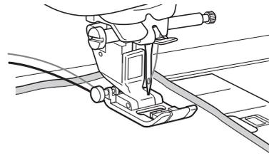
**14** Tout en maintenant légèrement les fils à l'arrière de la machine, tournez le volant pour refaire passer l'aiguille dans le tissu ou le trou percé, puis abaissez le levier du pied-de-biche.
